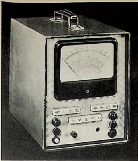
Bild 1. Elektronisch gesteuertes, vollautomatisches Röhrenvoltmeter
